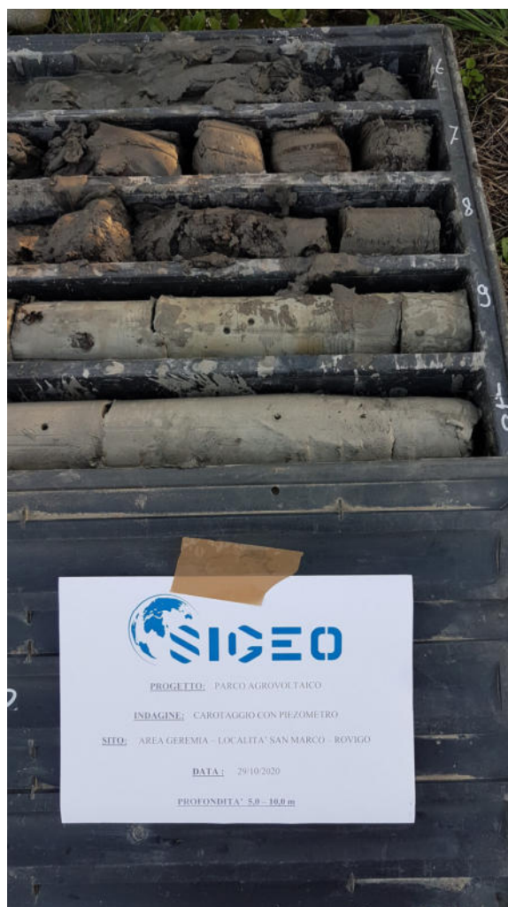
Figura 18: cassa sondaggio geognostico SP3 da – 5,00m a – 10,00 m da p.c.
