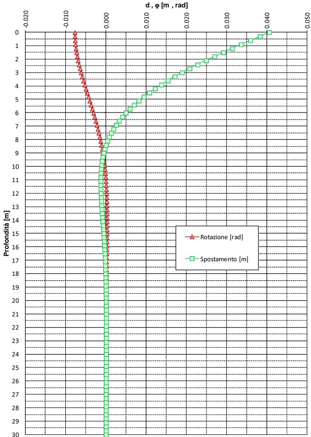
**FIGURA 6-2: SPOSTAMENTI E ROTAZIONI – PALI TRIVELLATI φ 1200 (TAGLIO IN TESTA)**
