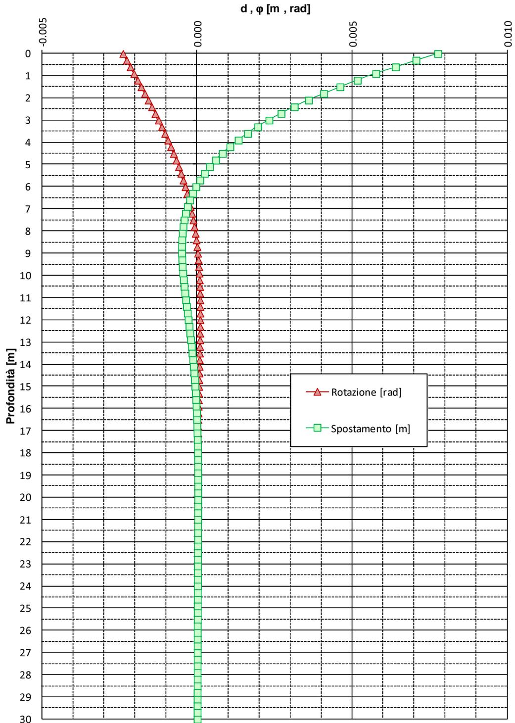
**FIGURA 6-4: SPOSTAMENTI E ROTAZIONI – PALI TRIVELLATI φ 1200 (MOMENTO IN TESTA)**
