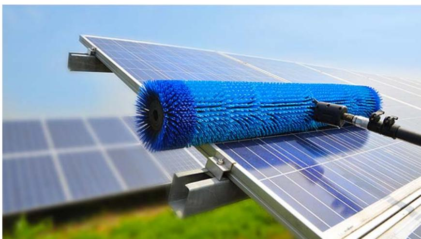
Figura 3-24 – Sistema di pulizia pannelli con rotospazzola
