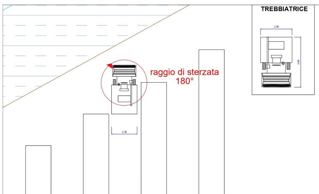
Figura 3-23 - Rappresentazione del raggio di sterzata del macchinario per la trebbiatura
