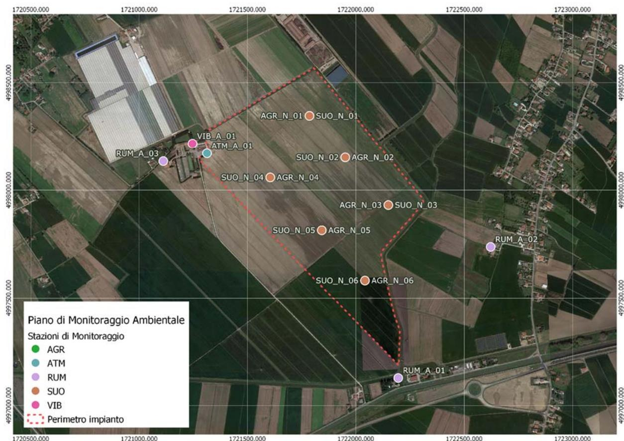
Figura 14 – Ubicazione dei punti di misura del Piano di Monitoraggio Ambientale
