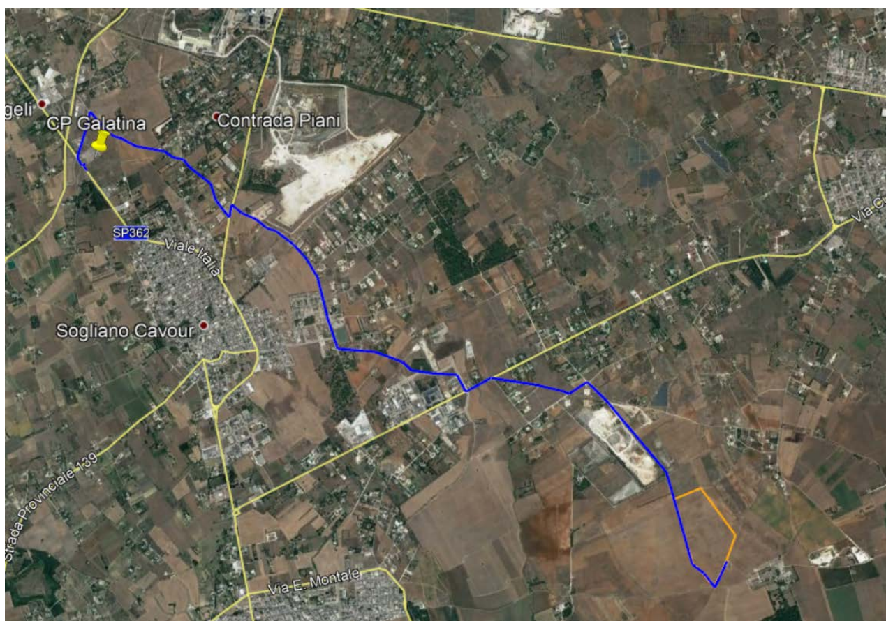
Figura 3-19 - Inquadramento su ortofoto soluzione di connessione interrata
