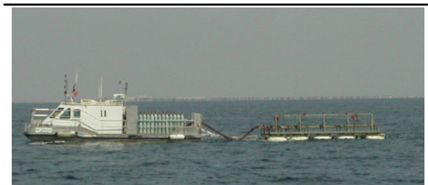
Figura 2.2.1.2a Nave Sorgente per Profondità Molto Basse (1-3 m)
