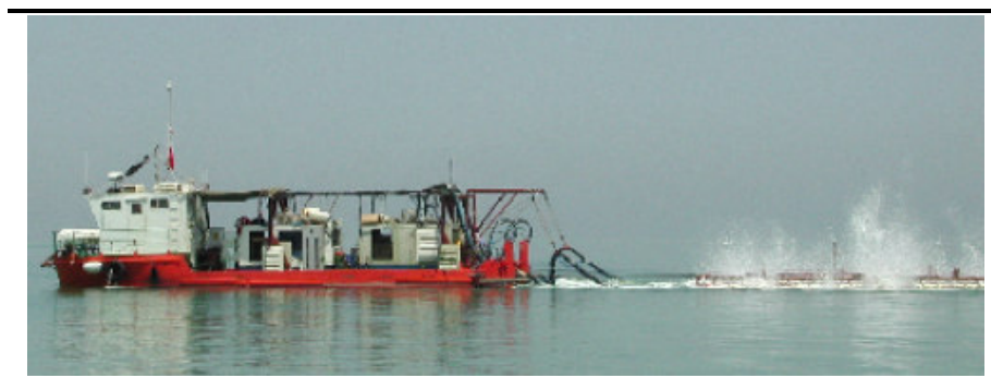
Figura 2.2.1.2b Nave Sorgente per Basse Profondità (3-20 m)
