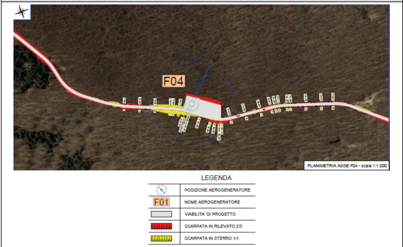
Piazzole e viabilità di accesso - Tavola 1454_G9 “Planimetria e profilo Asse F04” (stralcio)
