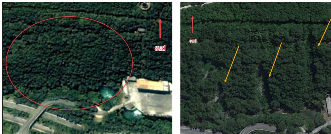
Figura 11: Immagini satellitari del versante nel tratto ad est della centrale (da Google Earth). In alto immagine riferita all'anno 2004, in basso dettaglio del versante nel 2016 con indicate le aree dove si sono sviluppati i dissesti
