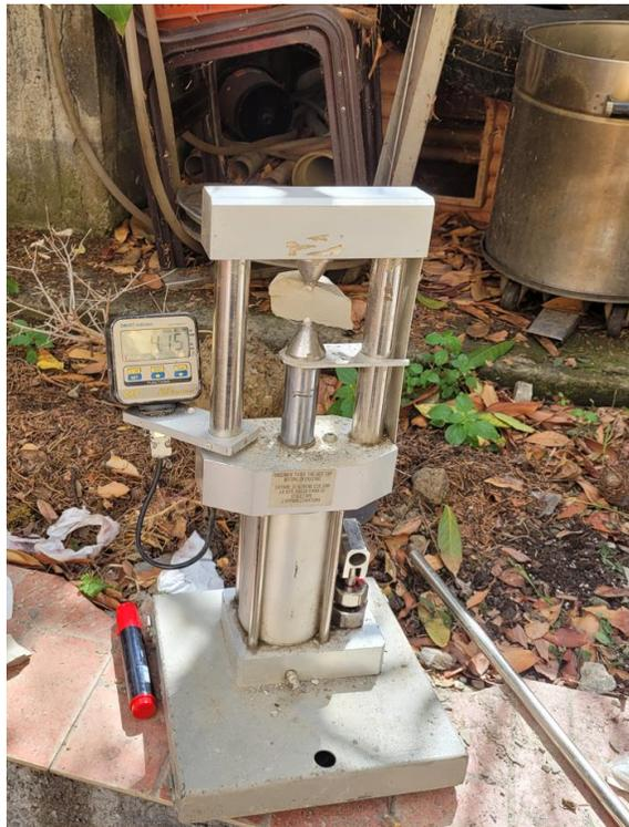
**Figura 1:** esempio di esecuzione di una prova mediante apparato di Point-Load.
