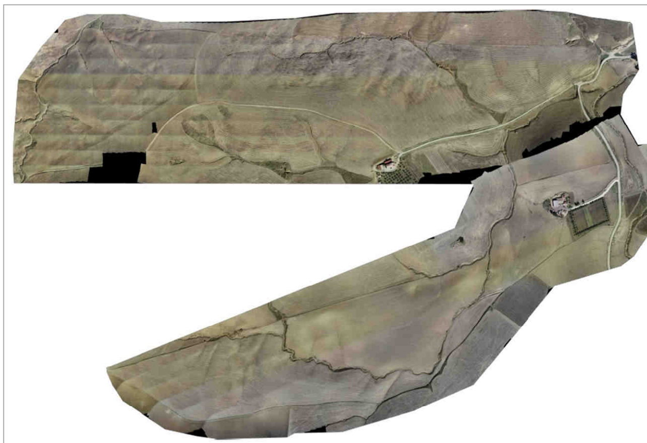
Rilievo aerofotogrammetrico dell'area del campo agrivoltaico eseguito con Drone
