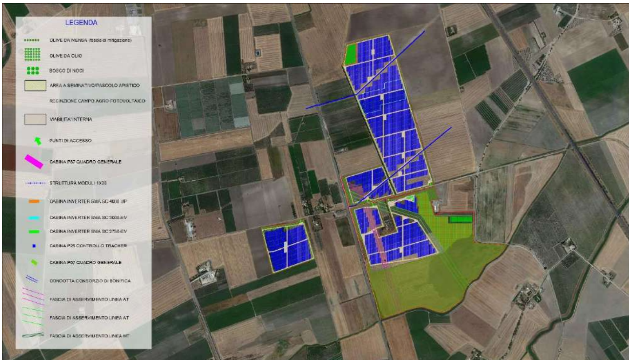
Figura 5 – Layout impianto agro-fotovoltaico
