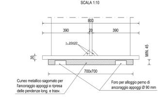
Cuneo metallico sagomato per ancoraggio appoggi e tenuta delle pendenze long. e trasv.
