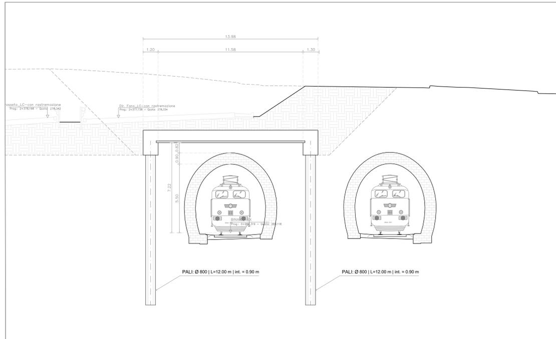
SEZIONE TRASVERSALE MANUFATTO DI SOSTEGNO GALLERIA FERROVIARIA C-C'
