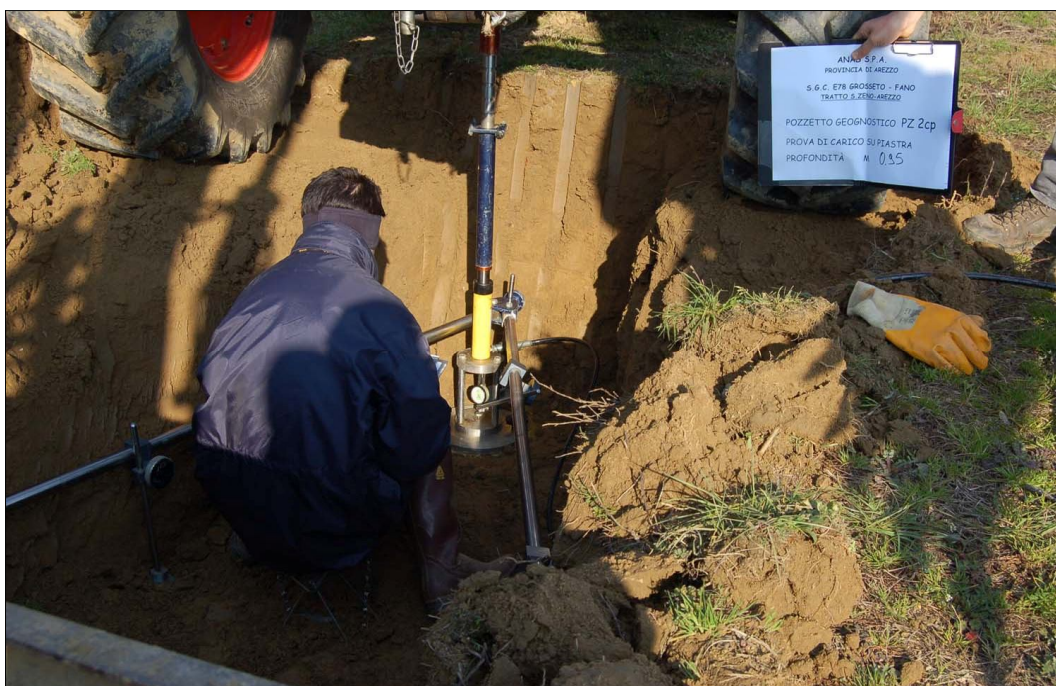
Foto 2 - prova di carico su piastra
