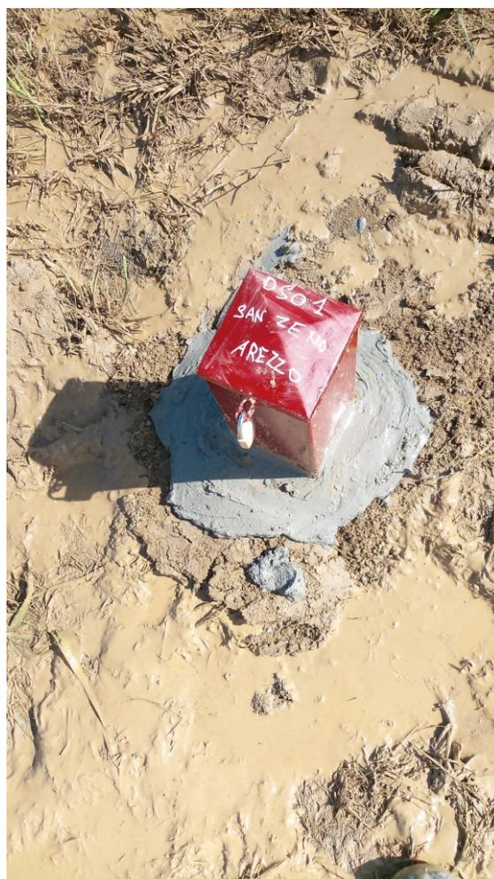
Pozzetto di protezione in ferro
