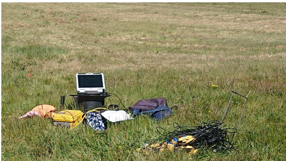
Per il rilievo della velocità del moto del suolo sono stati utilizzati geofoni *Geospace*, con frequenza di oscillazione di 10 Hz verticali ed orizzontali (a rifrazione in Onde P ed S) e di 4.5 Hz (MASW).
