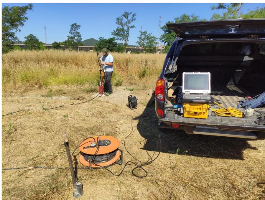
**Esecuzione indagine sismica Down-Hole SC06**
