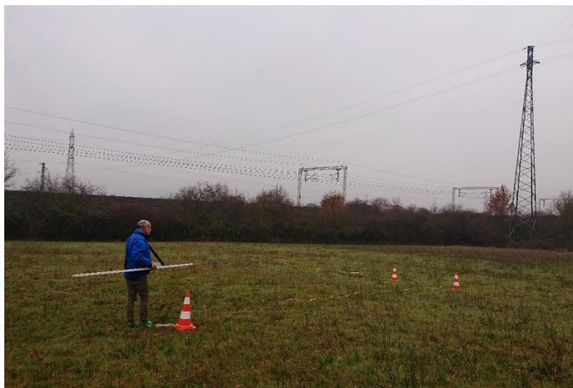
Esecuzione delle misure elettromagnetiche con GEM2 (tratto C)
