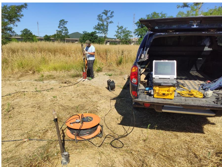
**Esecuzione indagine sismica Down-Hole SC06**
