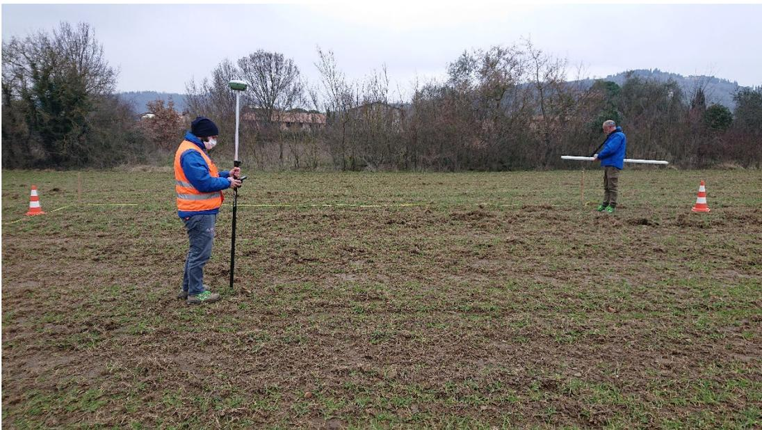
**Esecuzione della griglia di rilievo con GPS Rtk per le misure elettromagnetiche con GEM2**
