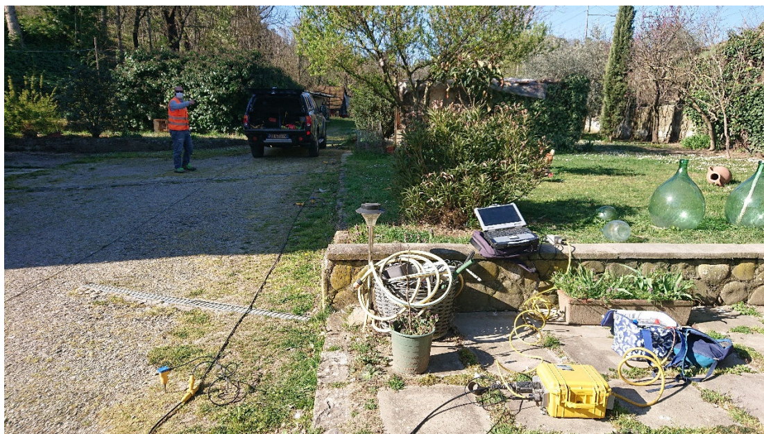
Esecuzione indagine sismica a rifrazione A_Sism03
