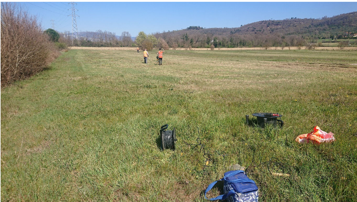
Esecuzione indagine sismica a rifrazione C_Sism01
