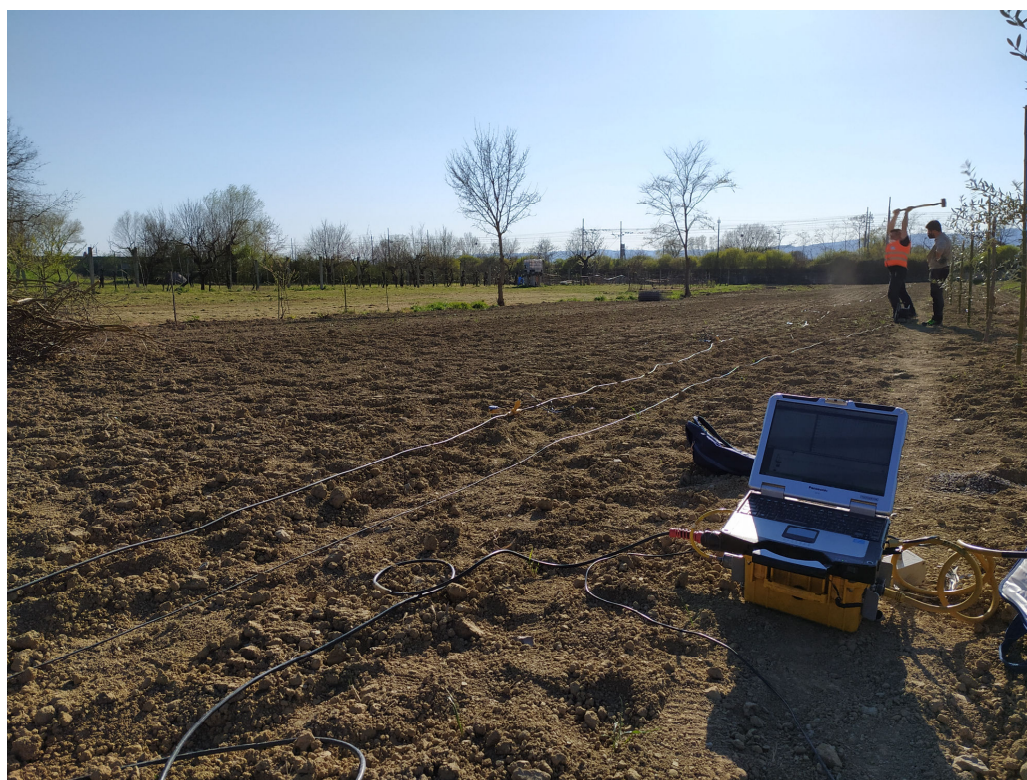
Esecuzione delle prospezioni sismiche a rifrazione D_Sism1 e D_Sism3
