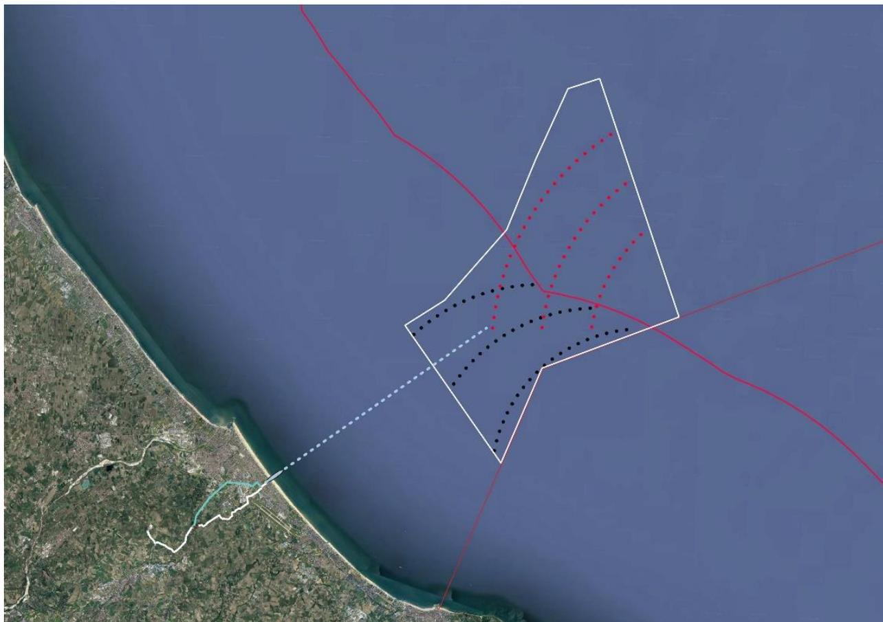
Figura 3.2 – Area in cui ricadono le alternative (in bianco) con LAYOUT A (in nero) e B, e opere di connessione
