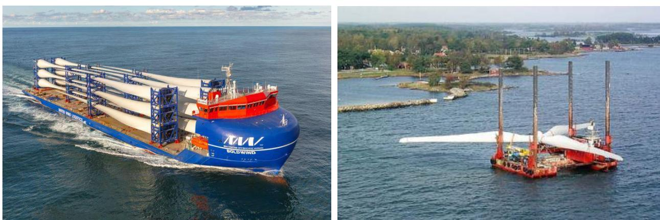
Figura 3.15 \_ Trasporto pale tramite chiatta; a destra, con rotore pre assemblato (Fonte: Breakbulk Project Cargo)
