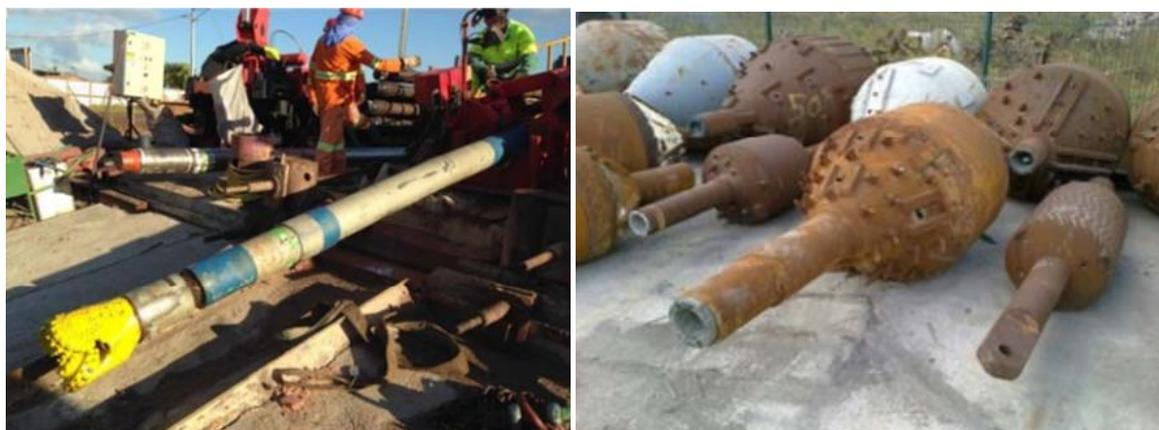
Figura 3.22 \_ Esempi di punta di perforazione HDD e Reamer
