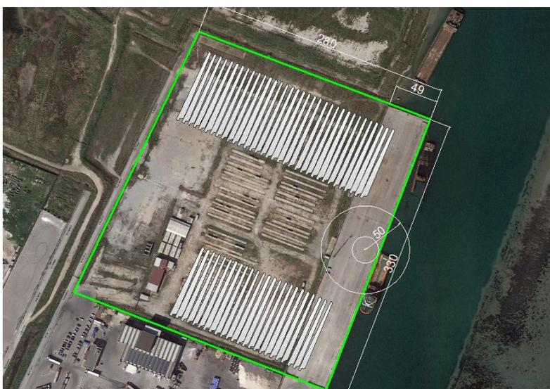
Figura 3.7 \_ Ipotesi di stoccaggio della pale
