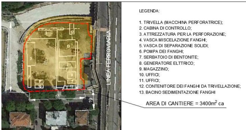
Figura 3.26 \_ Dimensione area proposta per il cantiere temporaneo per la realizzazione di HDD terra-mare .
