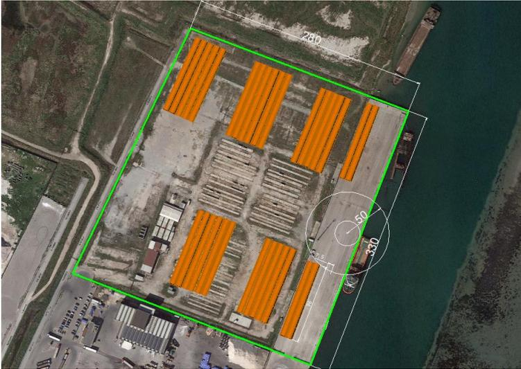
Figura 3.3 \_ Ipotesi di stoccaggio di monopali (stimata con la lunghezza massima pari a 96m)
