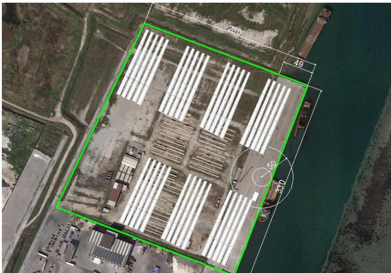
Figura 3.6 \_ Ipotesi di stoccaggio della torre
