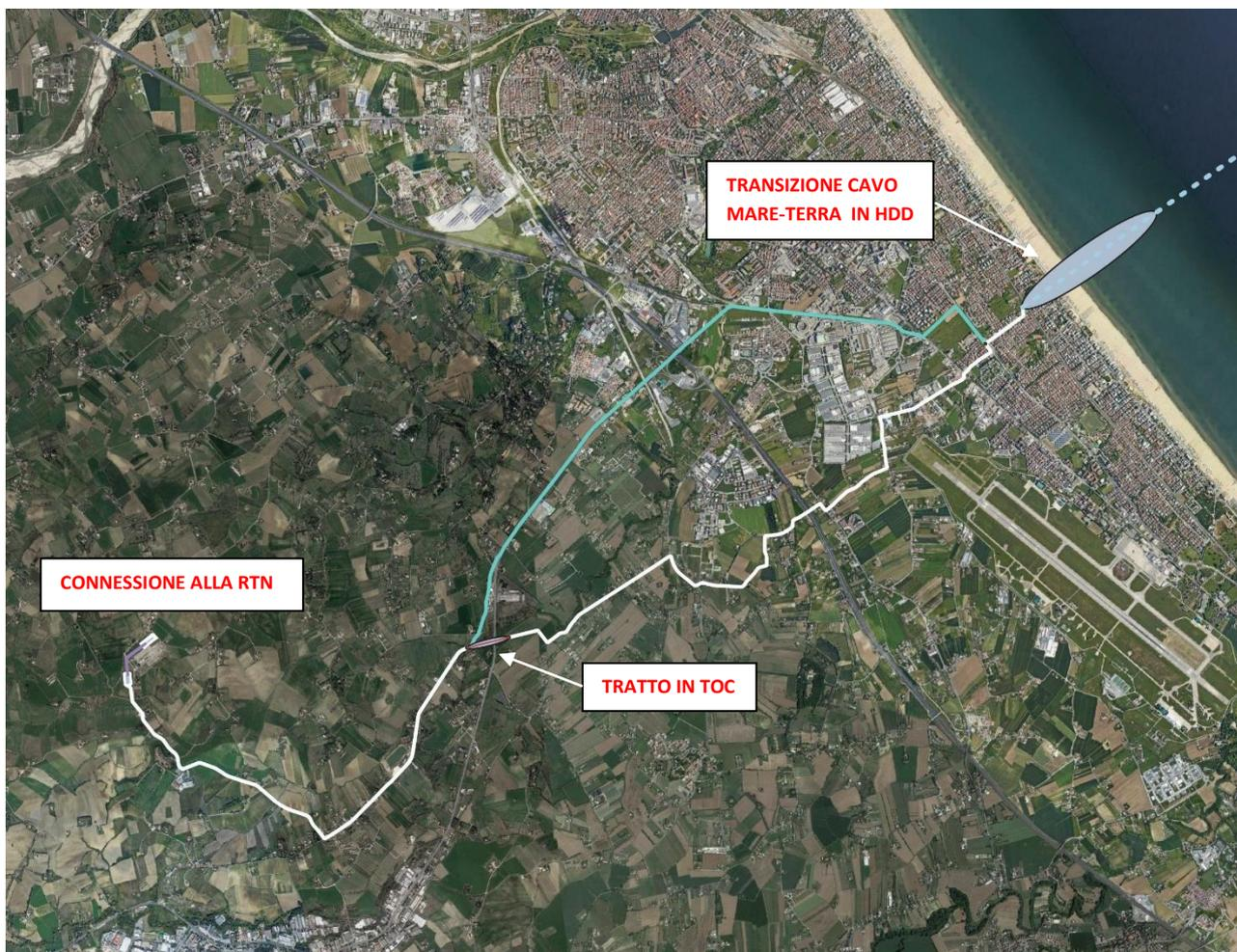
Figura 1.4 – Opere terrestri di collegamento della Centrale Eolica Offshore alla RTN;
