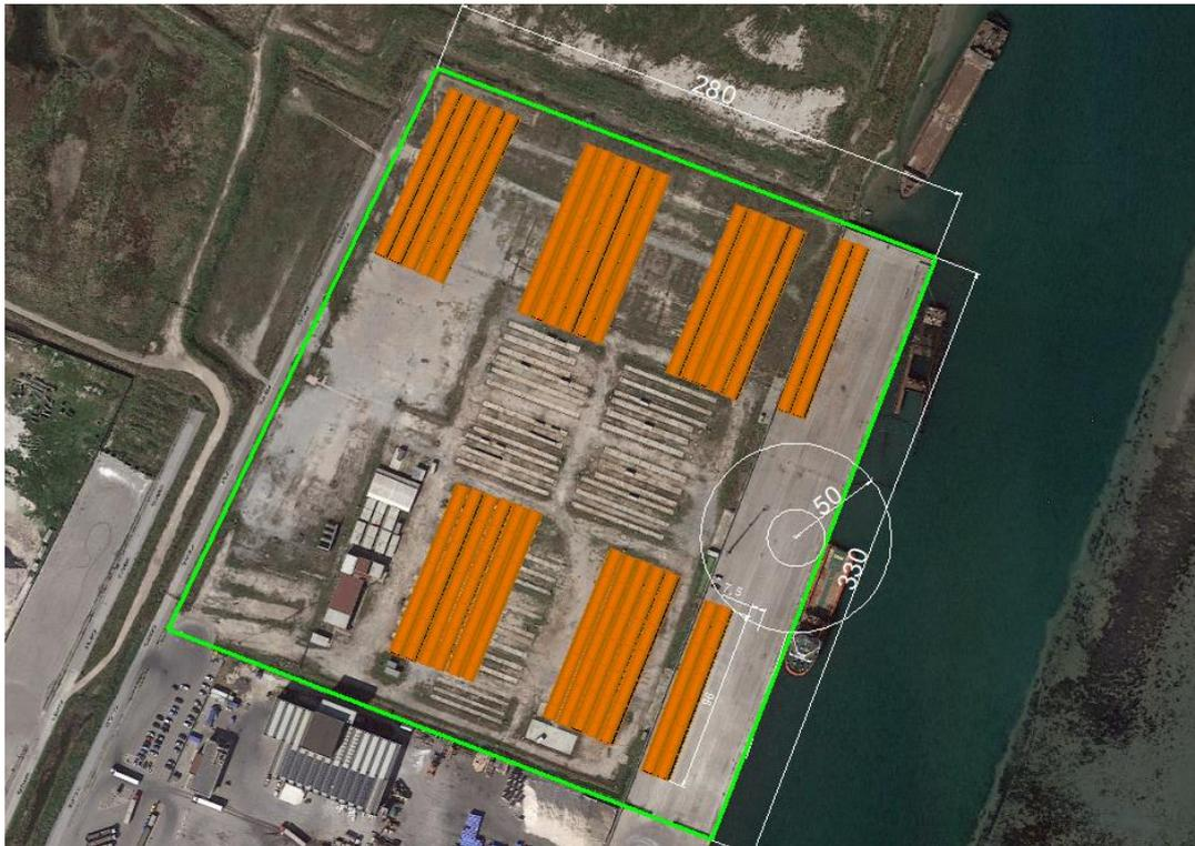
Figura 5-3 Ipotesi di stoccaggio di monopali (stimata con la lunghezza massima pari a 96m)
