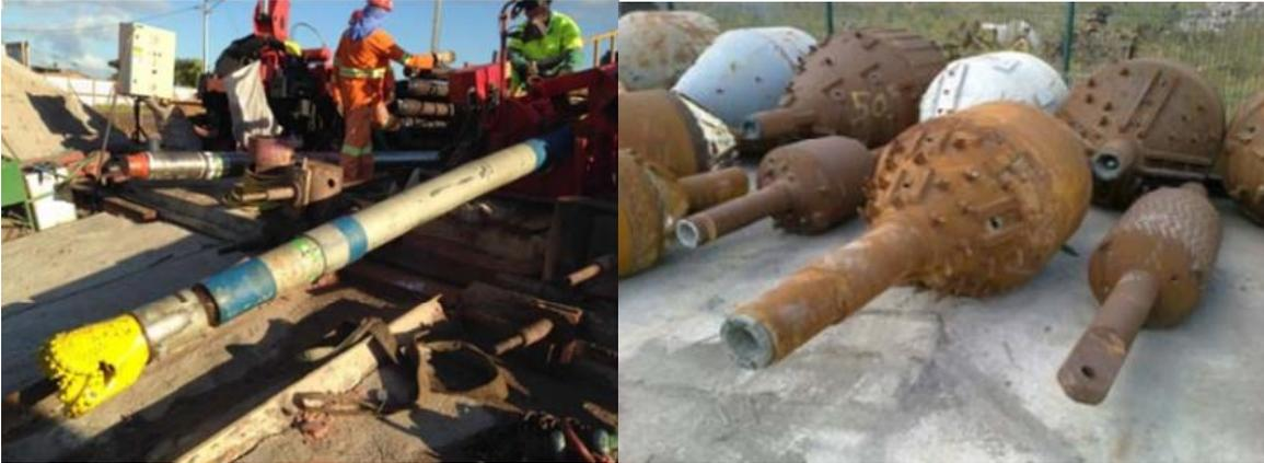
Figura 5-26 esempi di punta di perforazione HDD e Reamer
