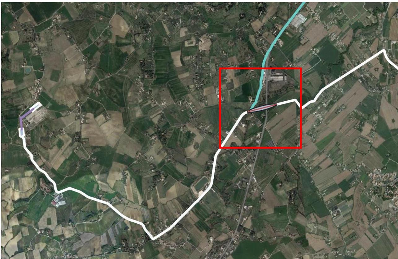
Figura 6.7 – Percorso del cavo 380 kV dalla buca giunti alla Stazione di arrivo (in bianco, il tracciato preferenziale)
