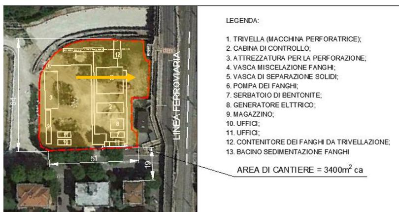
Figura 6-3 Dimensione area proposta cantiere temporaneo per la realizzazione di HDD terra-mare .
