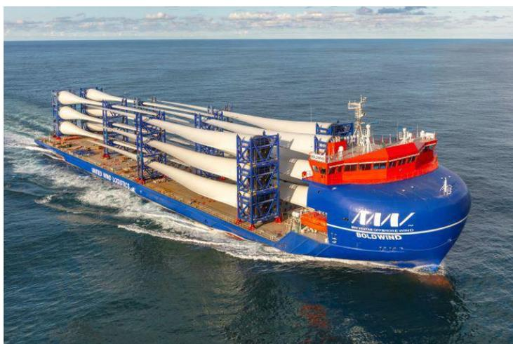
Figura 5-17 Esempio di trasporto di pale di turbine tramite chiatta (Fonte: Breakbulk Project Cargo)
