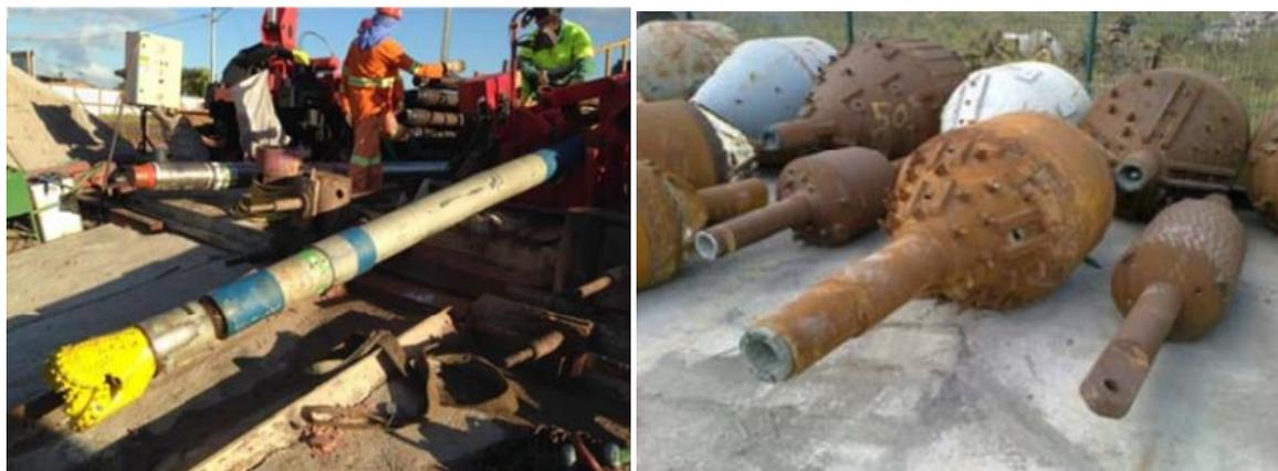
Figura 5.3 \_ Esempi di punta di perforazione HDD e Reamer
