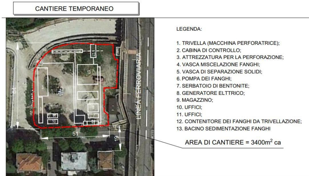
Figura 5.8 Pianta Area di cantiere a progetto per HDD.
