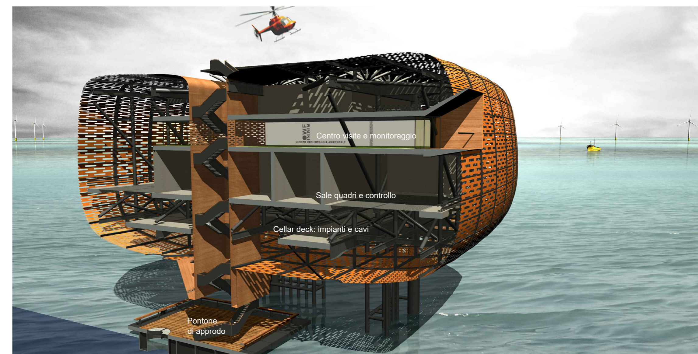
STAZIONE ELETTRICA SU PIATTAFORMA MARINA: SEZIONI PROSPETTICHE
