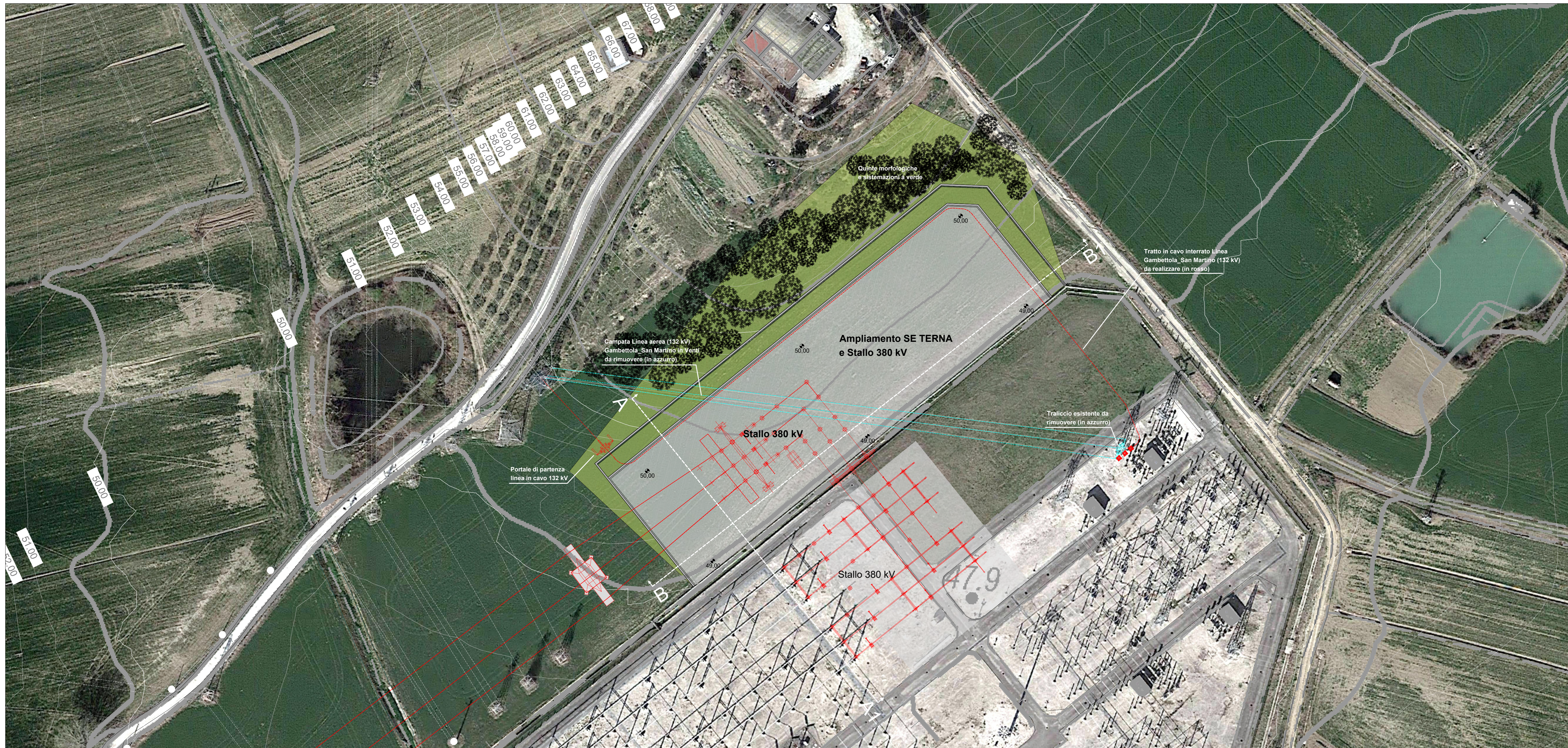
PLANIMETRIA SU ORTOFOTO E LINEE DI SEZIONE DELL'AREA DI AMPLIAMENTO DELLA STAZIONE TERNA S. MARTINO IN VENTI, NECESSARIO PER REALIZZARE LO STALLO 380 kV DEDICATO Scala 1:500
