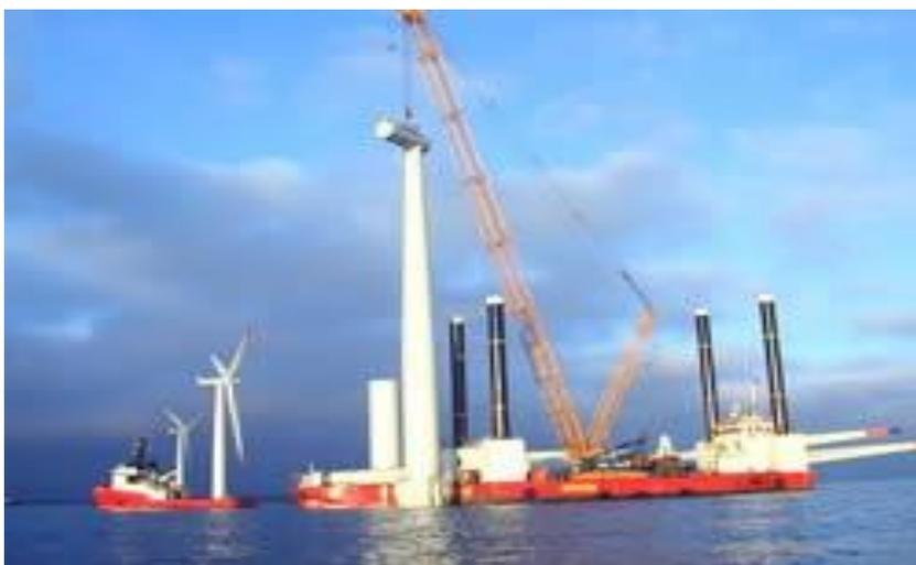
Figura 6.14 \_ Pontone durante l'assemblaggio di una navicella
