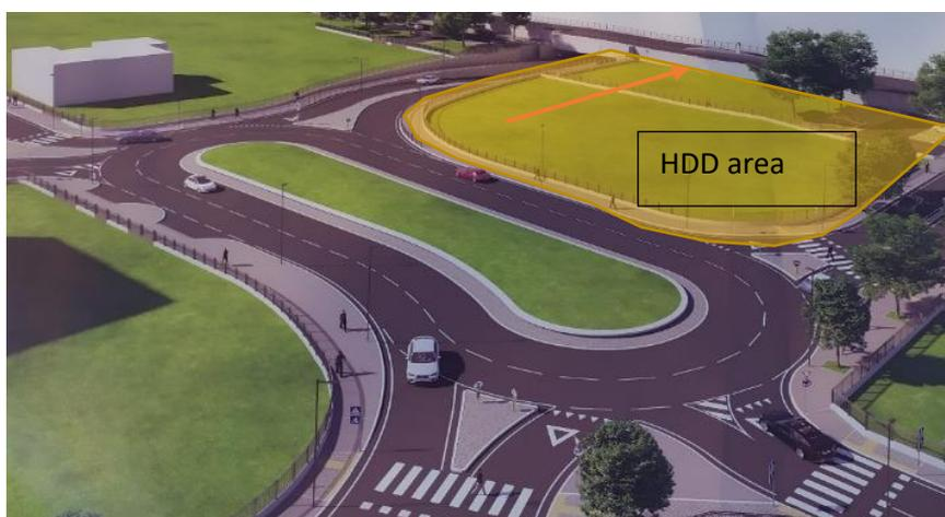
Figura 6.27 \_ Rendering area proposta per la realizzazione postazione di recupero HDD terra-mare.
