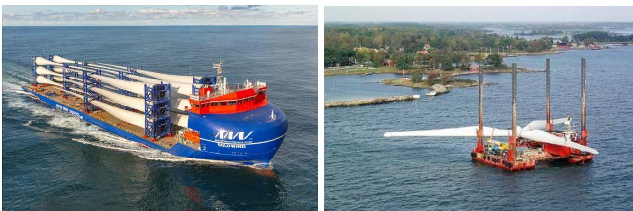
Figura 6.15 \_ Trasporto pale tramite chiatta; a destra, con rotore pre assemblato (Fonte: Breakbulk Project Cargo)
