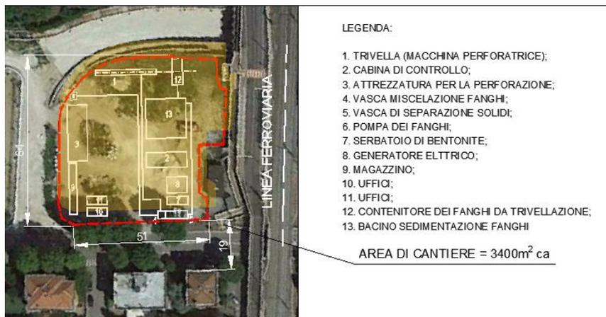
Figura 6.26 \_ Dimensione area proposta per il cantiere temporaneo per la realizzazione di HDD terra-mare .
