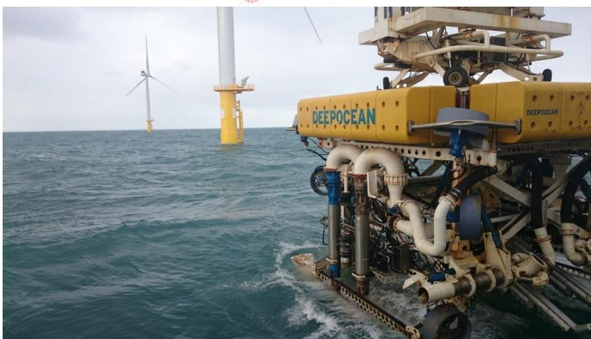
Figura 6.20 \_ Esempio di post trenching jetting macchine (DEEPOCEAN)
