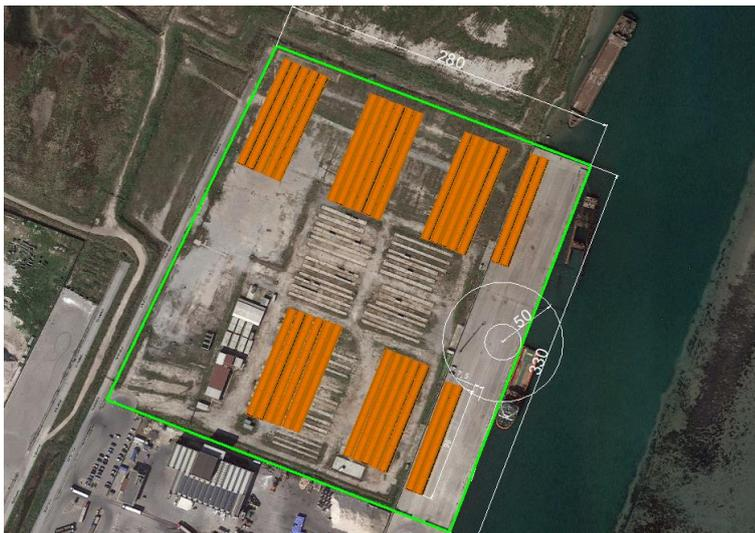
Figura 6.3 \_ Ipotesi di stoccaggio di monopali (stimata con la lunghezza massima pari a 96m)
