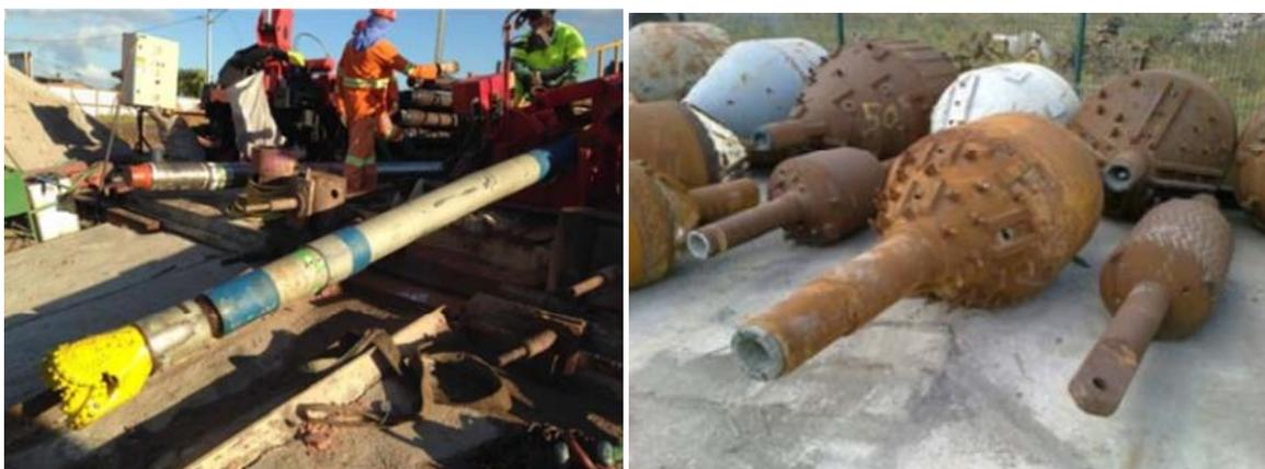
Figura 6.22 \_ Esempi di punta di perforazione HDD e Reamer
