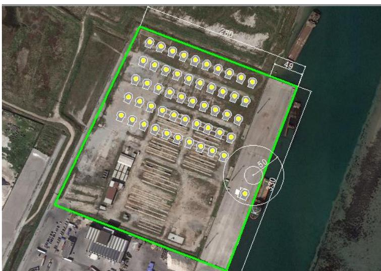
Figura 6.4 \_ Ipotesi di stoccaggio di giunti di transizione
