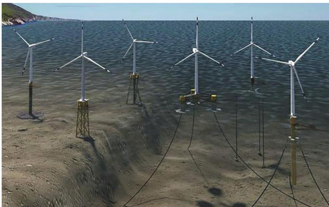
Figura 4.3 – Tipologie di fondazioni utilizzate in ragione della profondità e delle caratteristiche dei fondali
