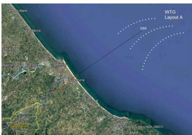
Figura 6.1 – Ubicazione delle turbine del Campo Eolico "Rimini" della Sottostazione elettrica secondo il layout "A". La minima distanza da costa è di circa 11 km.
