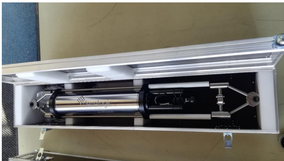
Figura 6.5 - Idrofono utilizzato per rilevamento dati sonori per la relazione di Quiet Ocean (prog. Soundscape)
