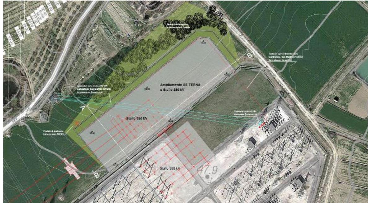
L'ampliamento è realizzato livellando a quota del piazzale TERNA (49 m slm) una porzione di terreno posta un pendio mediamente acclive (14% di pendenza); l'andamento del pendio rende necessario contenere il terreno a monte dello scavo con un sistema a gradoni con la realizzazione di due muri a scarpa di sostegno distanti tra loro 5 m, posti a quote differenti e raccordati da scarpate in terra.
