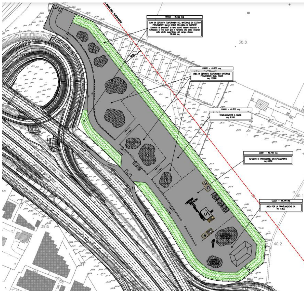
Figura 2: layout cantiere CO01 a nord dell'A14.
