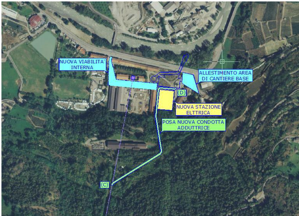
Fig. 3.42: Lotto III cantiere E fase II realizzazione condotta forzata tratto C-D
