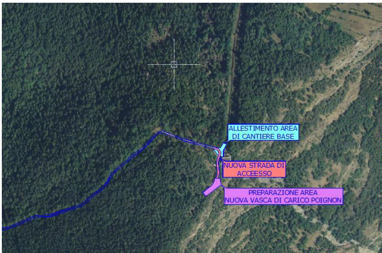
Fig. 3.38: Lotto II A cantiere D fase I Allestimento area vasca di carico
