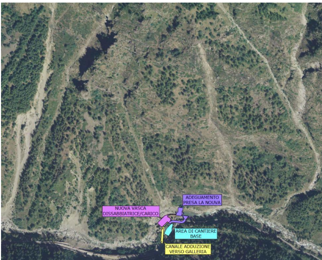
Fig. 3.45: Lotto IV cantiere F adeguamento opera di presa La Nouva
