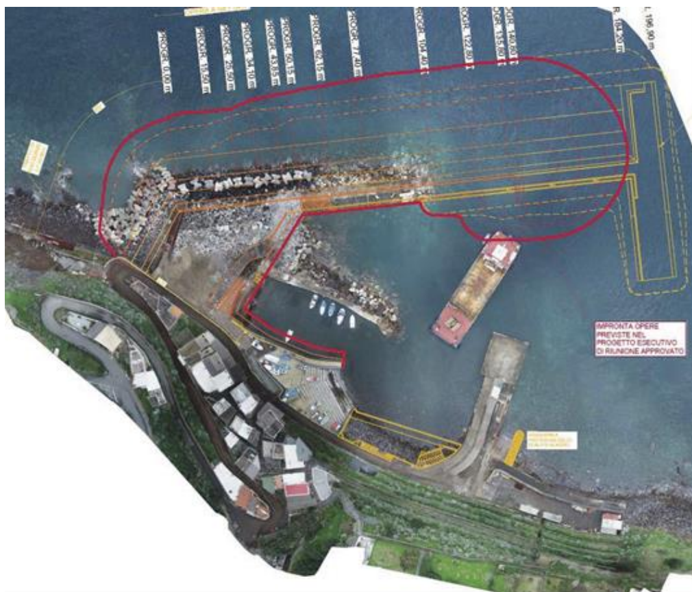
Layout previsto dalla Perizia di Variante con raffronto opere in progetto esecutivo di riunione e progetto di variante
