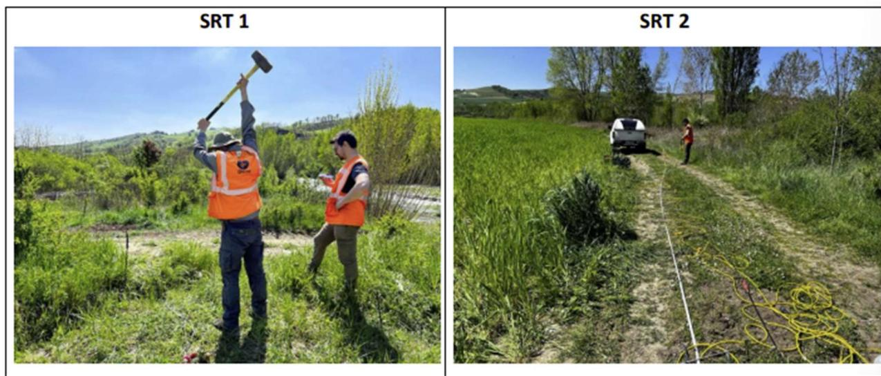
Figura 14 – Fasi della realizzazione della tomografia sismica
