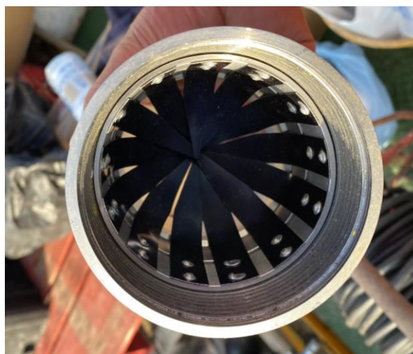
Figura 5. Catcher applicato a fondo liner per cercare di migliorare il recupero del sedimento.
