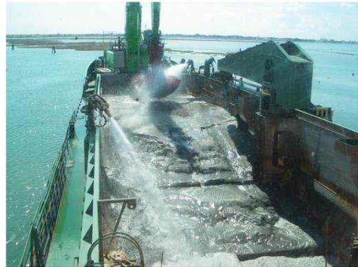
Figura 3.1-3 Water jet in azione
