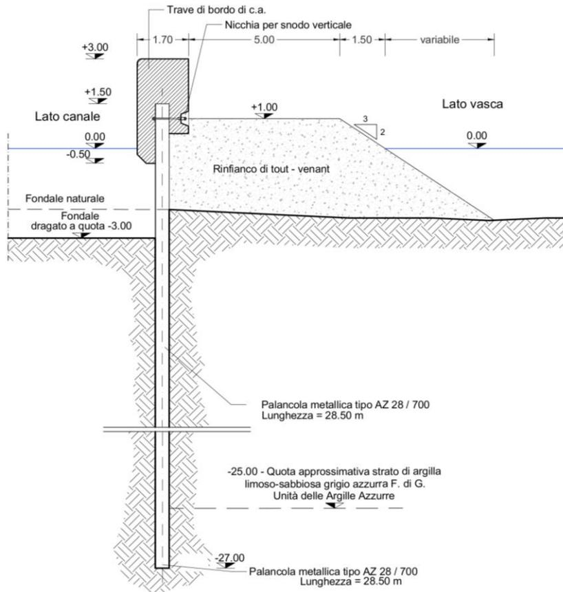
**Figura 2.4-3 Paratia metallica palanca AZ28-700 - lato canale (est della vasca)**
