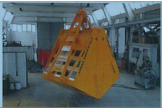
**Figura 3-2 Benna ecologica: A sx in posizione di apertura; A dx in posizione di chiusura**
