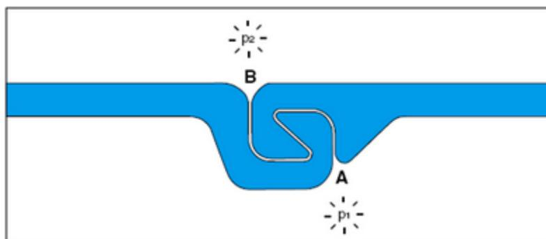
Figura 2.4-6 Sezione trasversale di un giunto tra palancole
