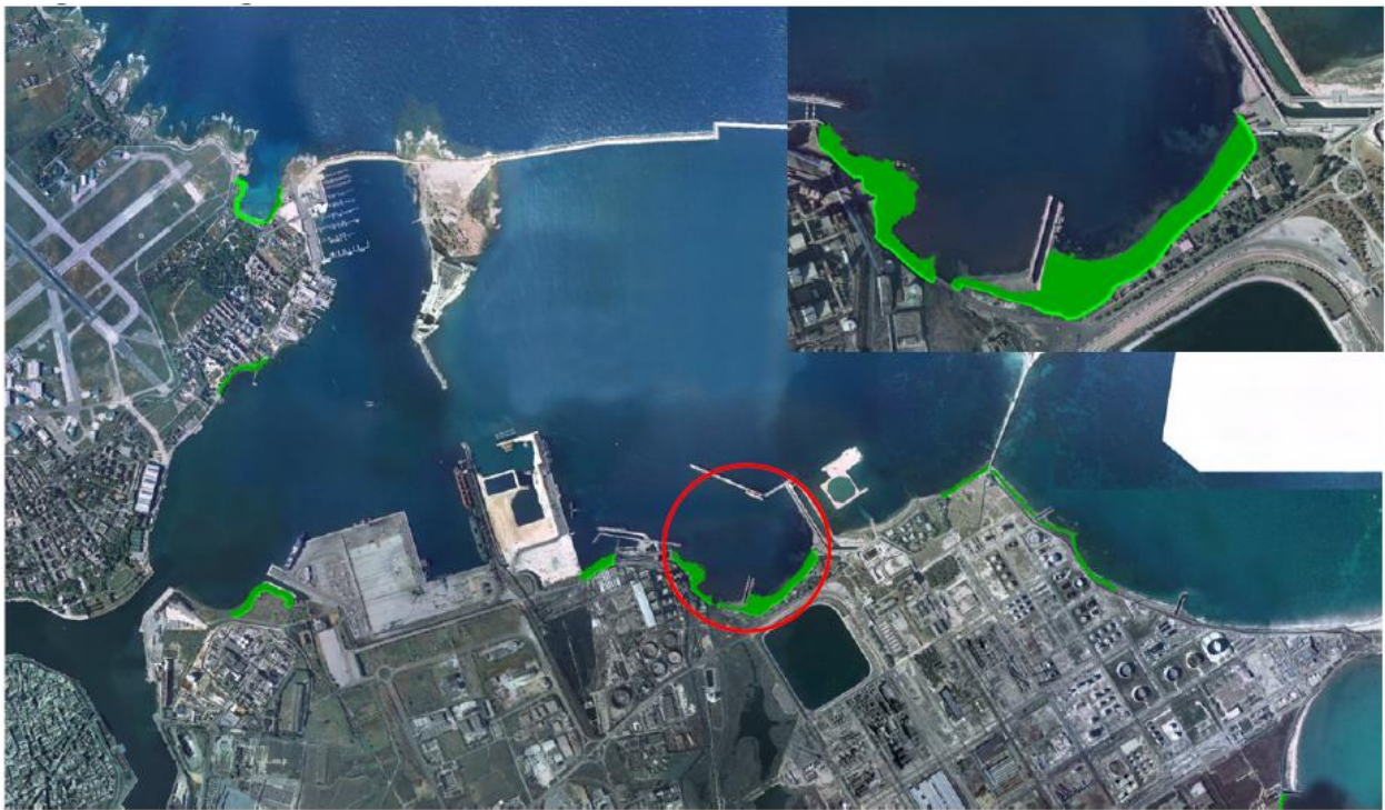
figura 10-1 – Zone a Pericolosità Geomorfológica molto elevata PG3 e PG2 (verde scuro e verde chiaro) – AdB WebGIS
