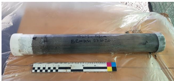
Foto 18: Liner campionamento manuale S01
