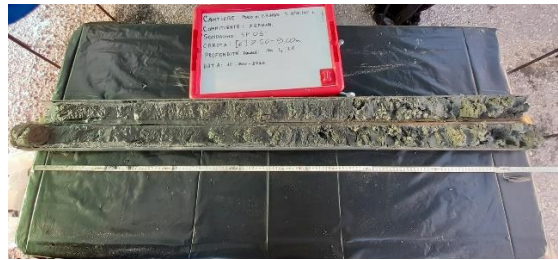
Foto 17: Liner sondaggio SP06 aperto
