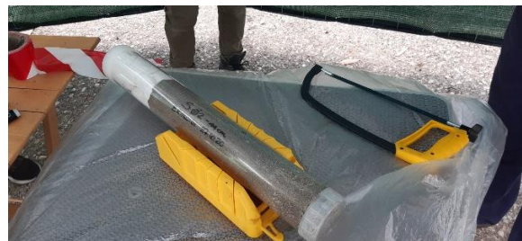
Foto 19: Liner campionamento manuale S02
