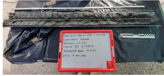
Foto 13: Liner sondaggio SP01 aperto
