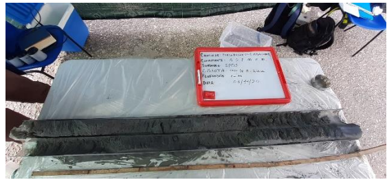
Foto 15: Liner sondaggio SP03 aperto
