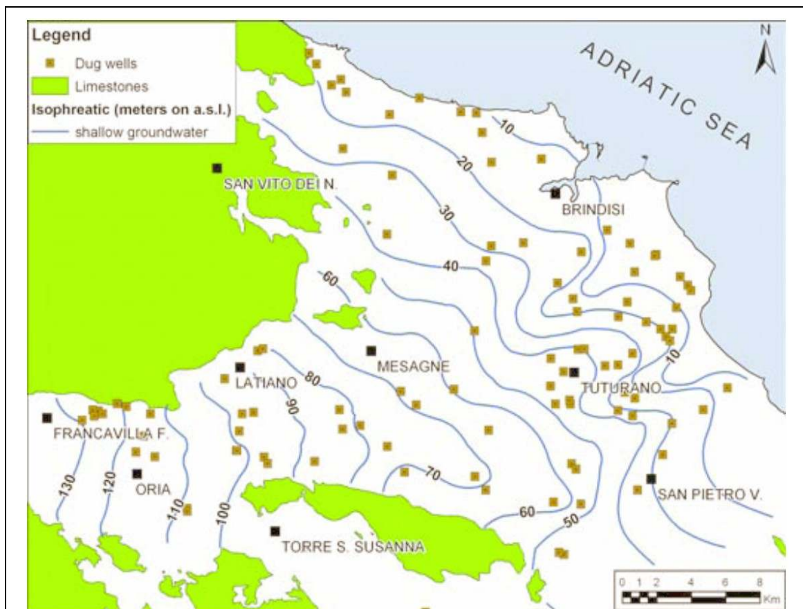
Fig. 7.3 – Distribuzione dei carichi piezometrici della falda superficiale (da Lopez et Al., 2008).
