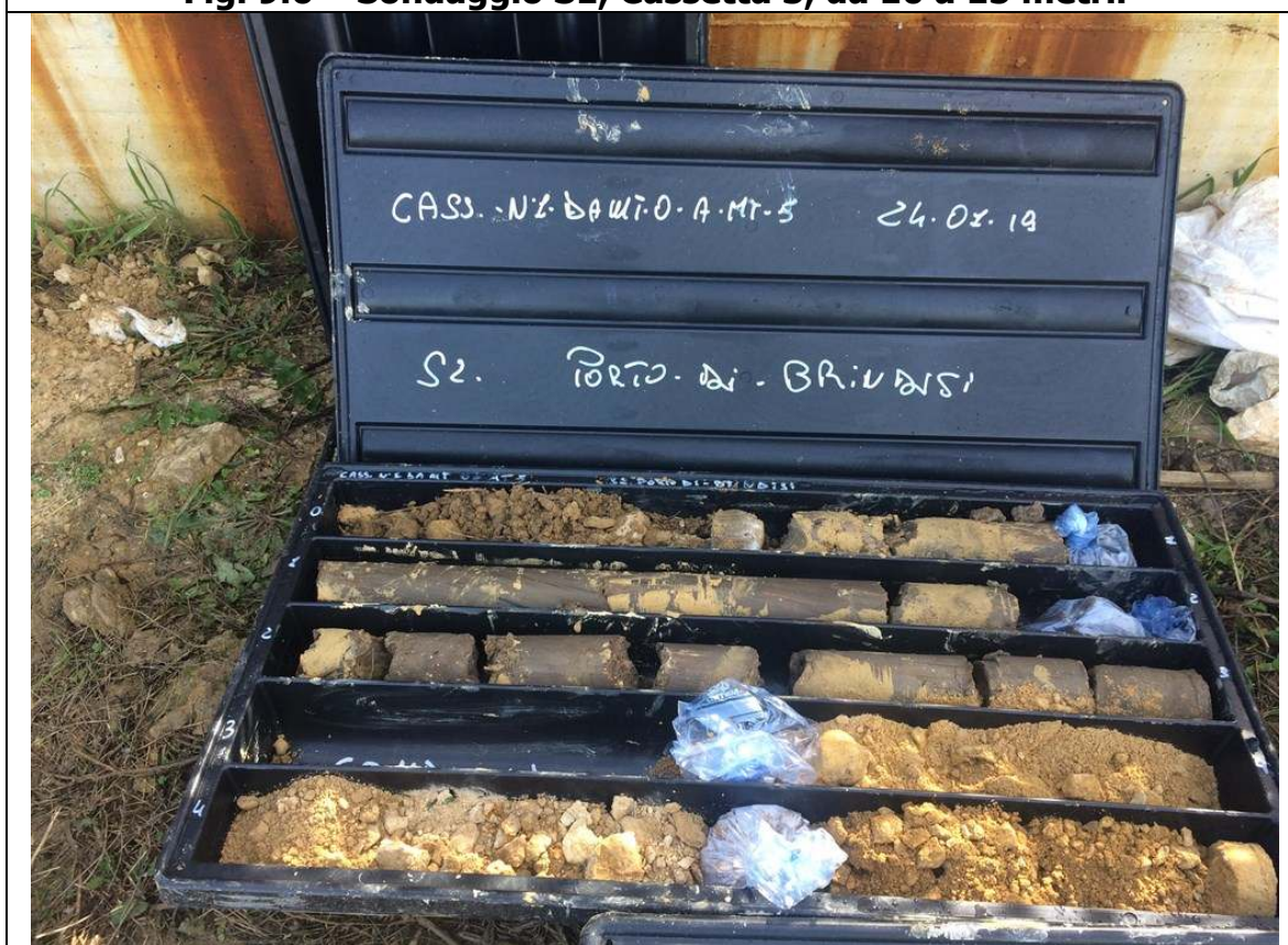
Fig. 9.7 – Sondaggio S2, Cassetta 1, da 0 a 5 metri.
