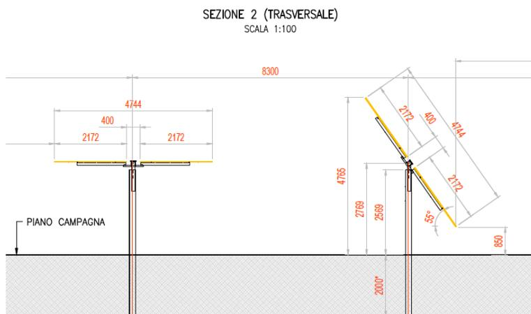
Figura 2.48: Particolare strutture di sostegno moduli
