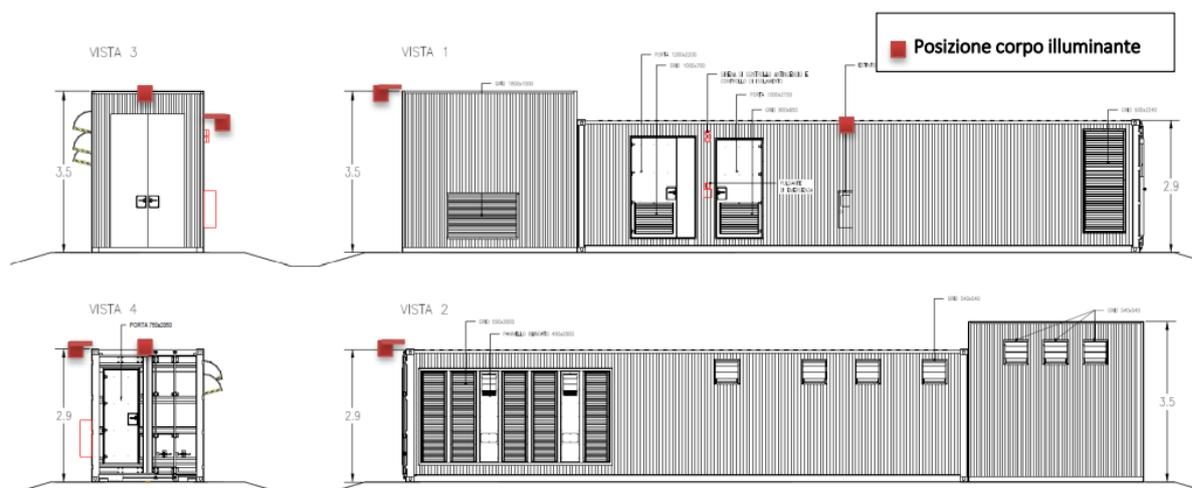
*Figura 4.37: Esempio di cabina e relativa indicazione della posizione dei corpi illuminanti.*
