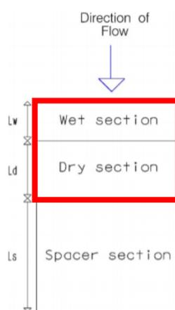
*Figura 4.63: modulo tipo descrivente il modello concettuale idrologico dell'installazione di strutture fotovoltaiche a tracker su pari infissi comprendente l'area pannelli (in rosso) e l'area di interfila (Fonte: Hydrologic response of solar farm Cook 2013 American Society of Civil Engineers)*
