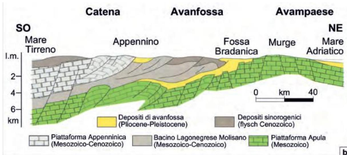
Figura 4.41: Sezione geologica schematica attraverso l'avanfossa appenninica.
