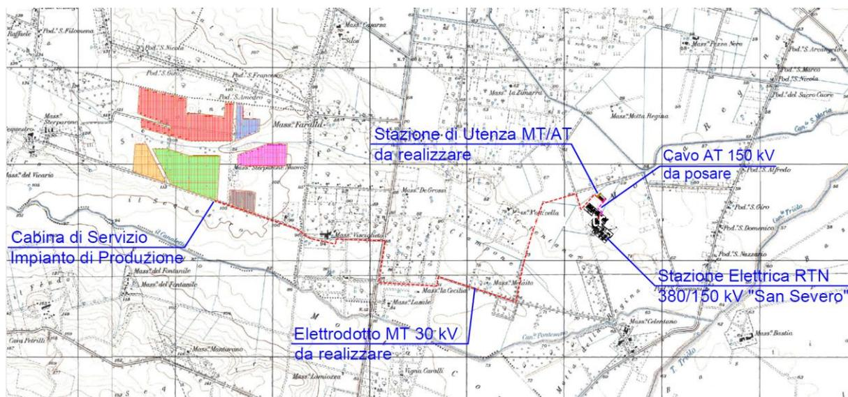
Figura 2.53: In rosso il percorso di connessione dal campo FV alla cabina di trasformazione
