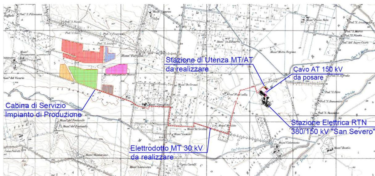
Figura 4.8: In rosso il percorso di connessione dal campo FV alla cabina di trasformazione
