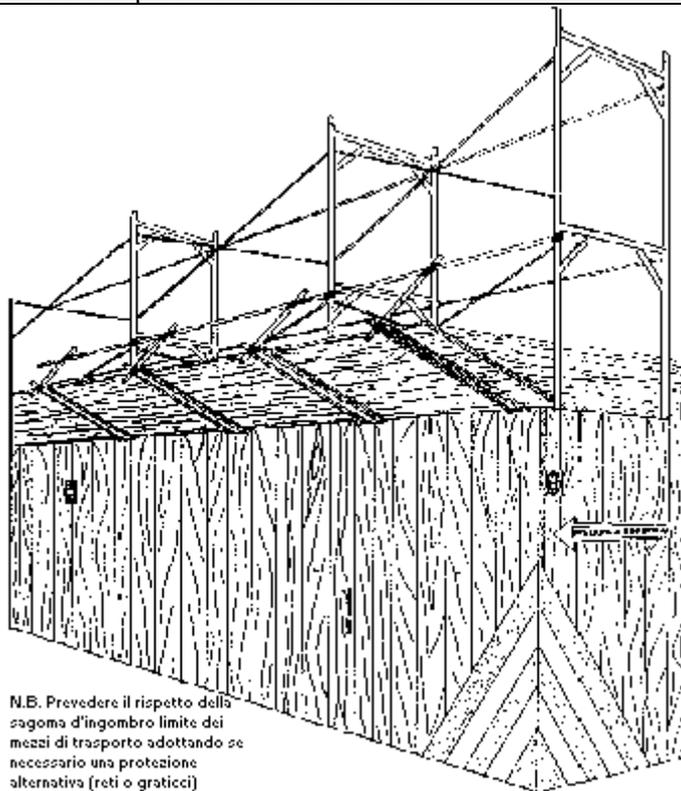
*Prescrizioni Organizzative:* Ponteggio metallico fisso: massimo dislivello con la costruzione. Il montaggio del ponteggio non dovrà svilupparsi in anticipo rispetto allo sviluppo della costruzione: giunti alla prima soletta, prima di innalzare le casseforme per i successivi pilastri è necessario costruire il ponteggio al piano raggiunto e così di seguito piano per piano. In ogni caso il dislivello non deve mai superare i 4 metri.
