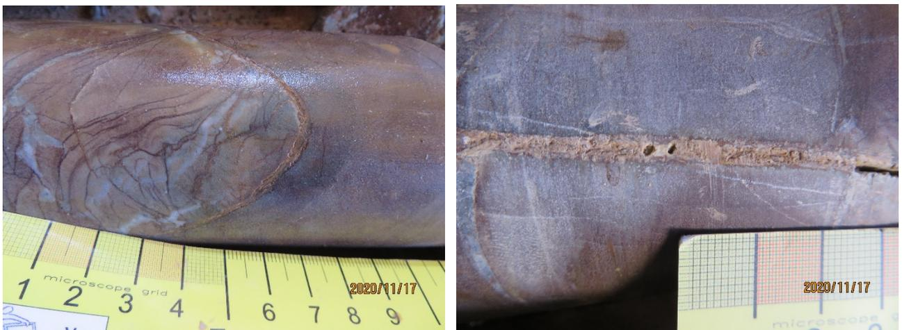
Figura 3.5.3: Dettaglio di un giunto J1/J2 ricementato e parzialmente aperto (sondaggio S2-1999, prof. 20 m circa).
