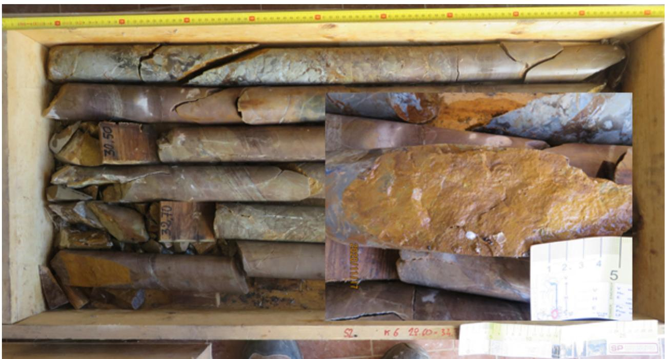
Figura 3.5.2: Dettaglio di un giunto J1/J2 con una patina argillosa. (sondaggio S2-1999, prof. 28 m circa).
