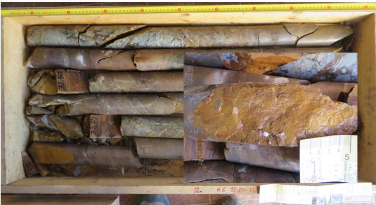
Figura 4.5.2: Dettaglio di un giunto J1/J2 con una patina argillosa. (sondaggio S2-1999, prof. 28 m circa).
