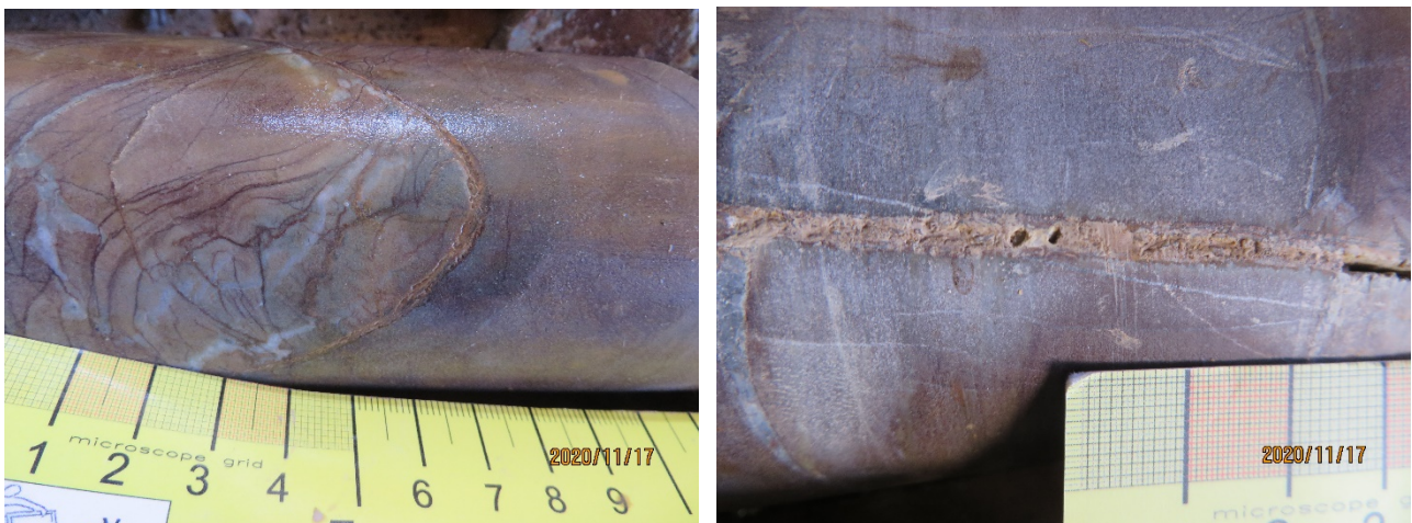
Figura 4.5.3: Dettaglio di un giunto J1/J2 ricementato e parzialmente aperto (sondaggio S2-1999, prof. 20 m circa).
