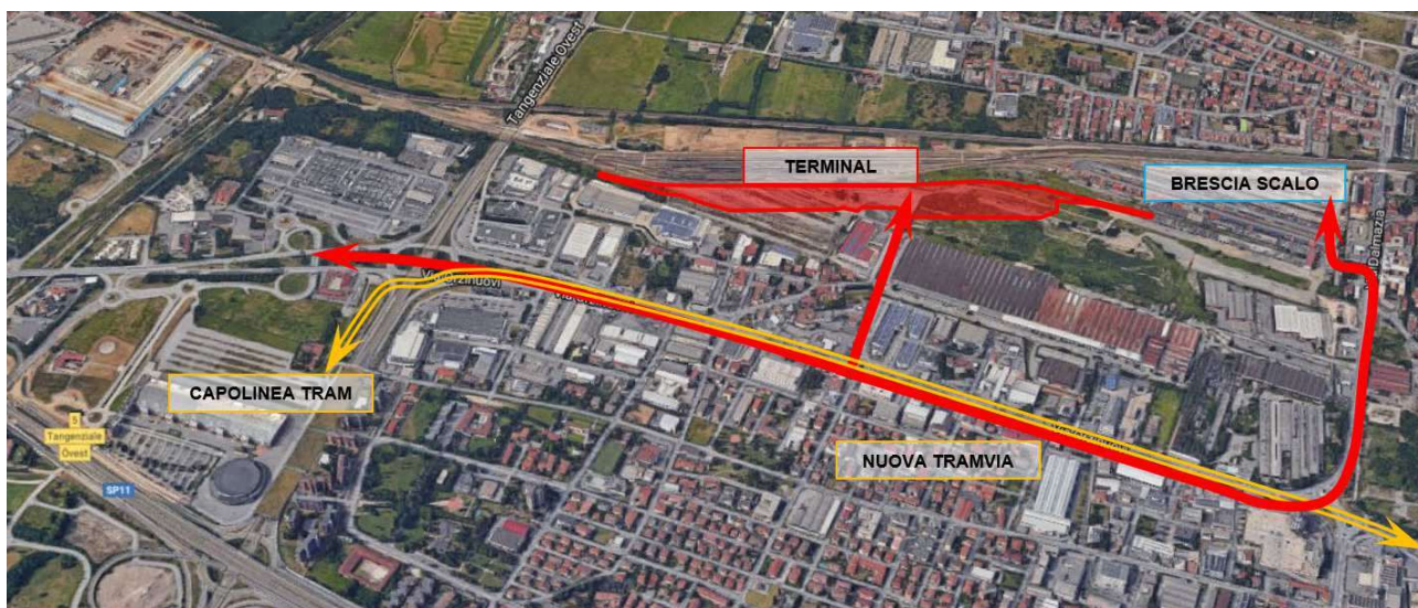
Interferenza tra flussi veicolari indotti dallo scalo merci di Brescia e la nuova linea tramviaria secondo il progetto definitivo
