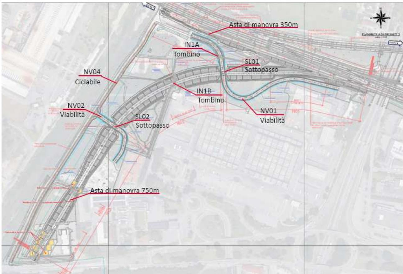
In particolare ci si riferisce alla viabilità di accesso alle aree prevista ed identificata nel sistema di opere stradali e sottovia identificati con NV01, NV02, NV04, SL01 e SL02. NV01e NV02 sono descritte come percorso di riconnessione aree “Parco Mella” necessarie a causa della realizzazione dell'asta di manovra le cui opere necessitano della realizzazione dei due sottovia SL01 e SL02.
