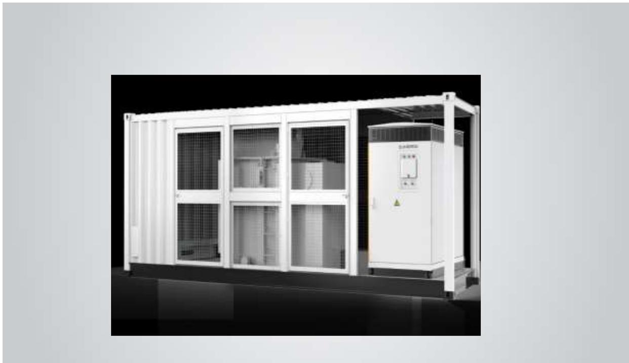
La megastation è in esecuzione stagna, dimensioni 6.058x2.896x2.438 mm, e integra sezionatori di ingresso lato DC, diodi anti inversione di polarità, fusibili di stringa, scaricatori lato Dc e lato AC, filtri e protezione dei guasti contro terra.
