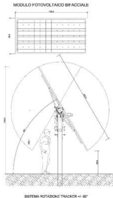
La struttura di sostegno scelta per l'impianto consente l'infissione nel terreno senza fondazioni; tale struttura permette:
