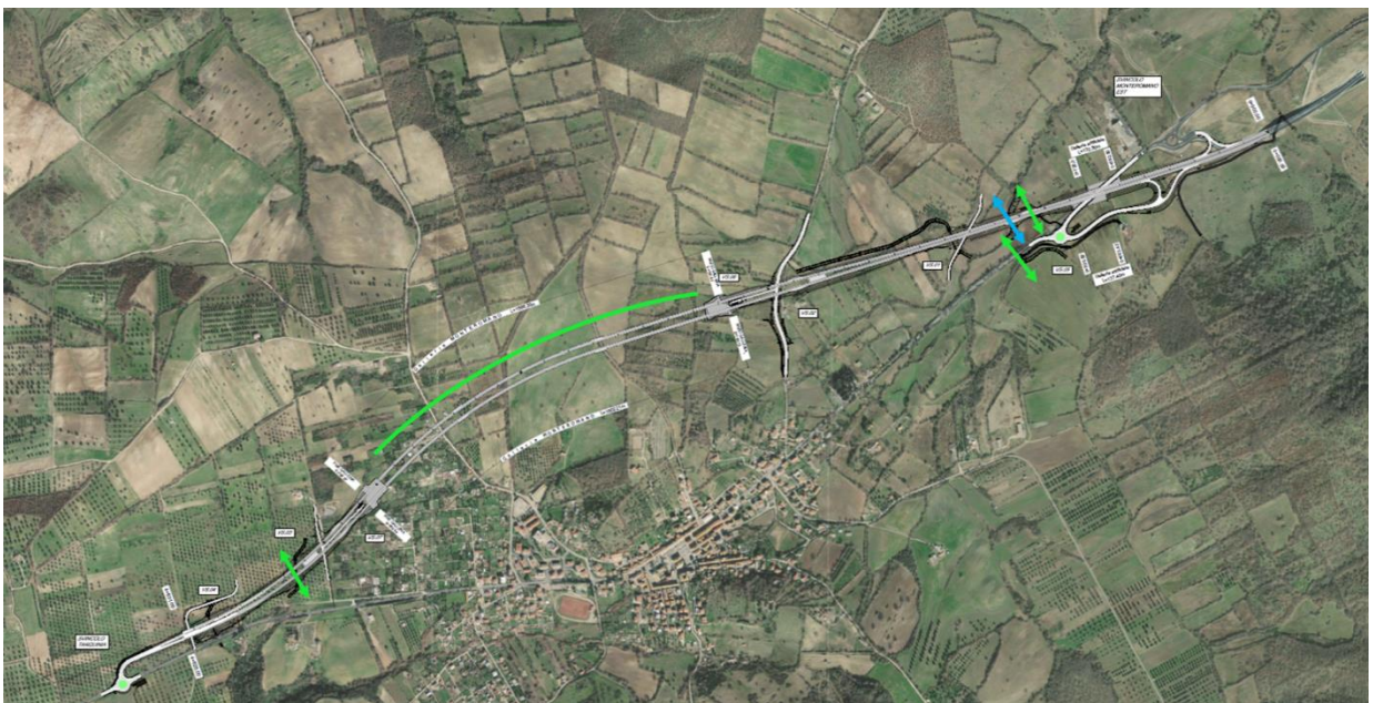
Figura 2-6: Elementi di permeabilità dell'infrastruttura in esame. In verde si evidenziano l'area della galleria naturale di Monte Romano ed i passaggi faunistici previsti, in azzurro l'attraversamento del Fosso Lavatore.
