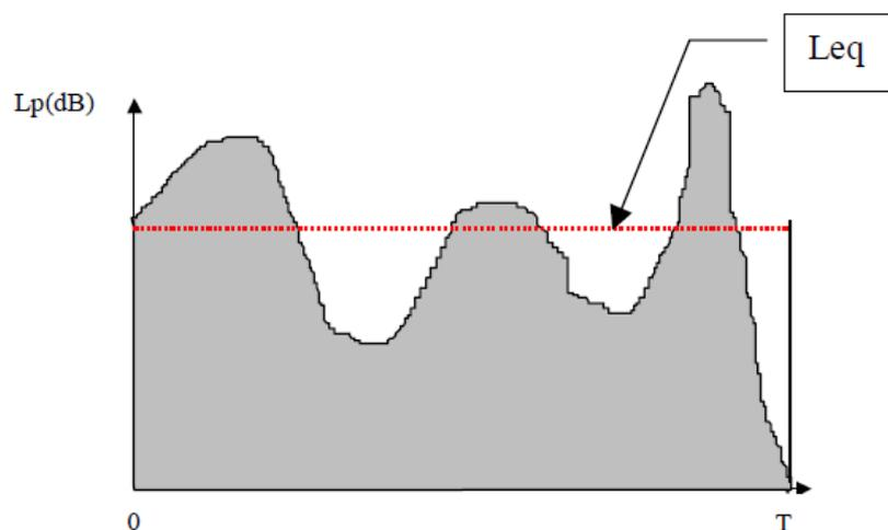
Per valutare l'effetto di disturbo che il rumore provoca sugli individui sono state elaborate altre grandezze e tra queste quella di maggiore diffusione, soprattutto per la praticità di misurazione mediante un semplice fonometro, è quella del livello sonoro in dB (A).
