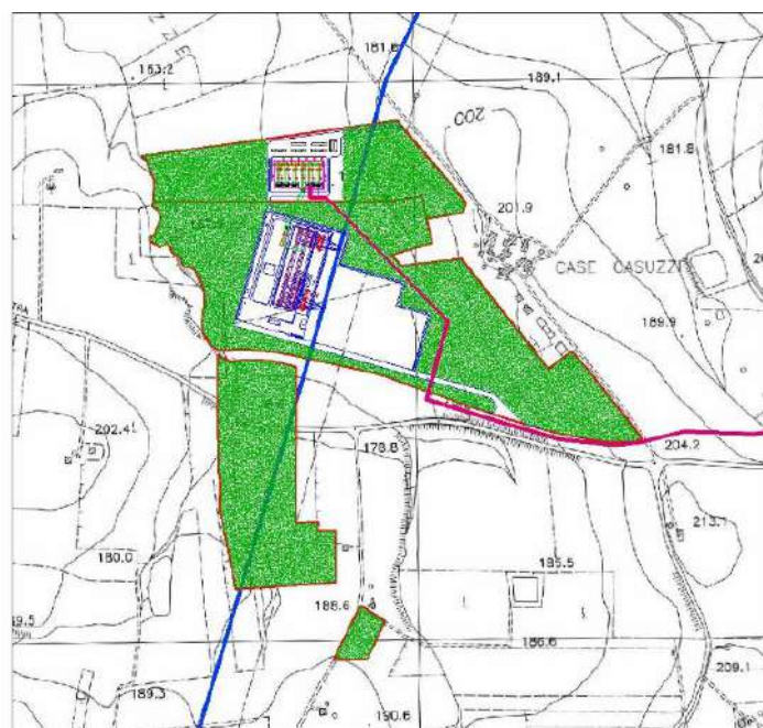
Figura 4 B – Layout della stazione ricadente sul territorio di Gibellina (TP - Contrada Casuzze) con cavidotto (TAV. IT-LAY)
