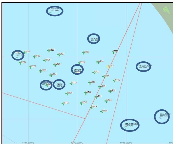
Figura 1 - Estratto del sistema "Pelagus" utilizzato dalle Capitanerie di porto per il monitoraggio del traffico marittimo
