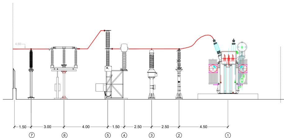
PIANTA E SEZIONE BB' - TRASFORMATORE
